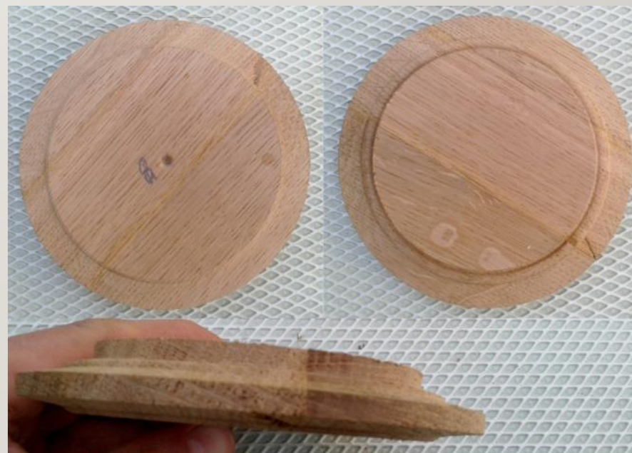
HOTOVÉ DNO PRIPRAVENÉ NA OSADENIE
