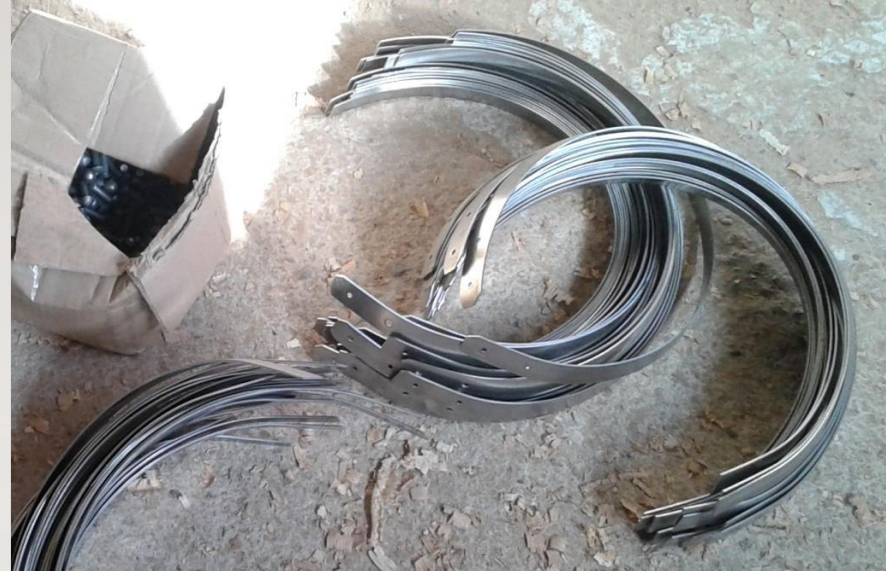
ÚÝROBA OBRUČE - VALCOVANÁ PÁSOVINA PRIPRAVENÉ NA NITOVANIE
